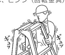
③開き止め金具が確実にロックするか点検してください。確実にロックできない場合は、絶対に使わないで廃棄してください。
