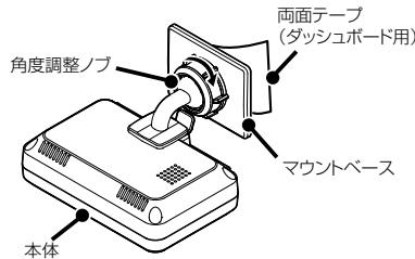
\* 必要に応じて、先にマウントベースを車両側に取り付けてから本体を設置してください。
