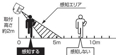
**人感センサーは周囲の温度変化を感知して作動する仕組みになっています。**
