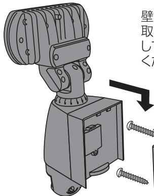
壁面にアンカー用プラグを埋め込んで取付用ベースをアンカーボルトで固定してから本体を矢印の方向に設置してください。
